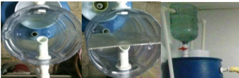
Figura 3. Clarificador para retención de sólidos gruesos
