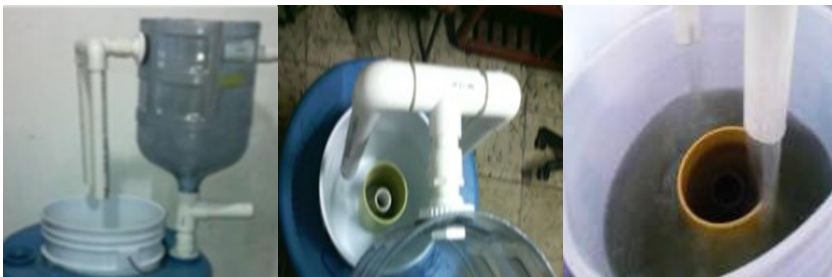
Figura 6. Desgasificación después del aclarador
