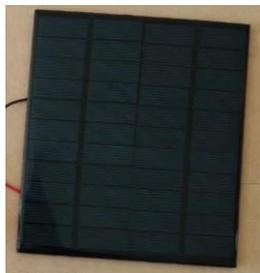
Figura 4. Panel solar de 2.5 watts de potencia.
