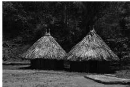
**Imagen 2. Construcciones Kogui de planta circular, cubierta cónica en palma y muros en madera en Pueblito (Sierra Nevada de Santa Marta)**
