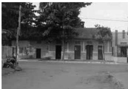
**Imágenes 28 y 29. Viviendas cerca a área fundacional de Ciénaga, de tipo vernáculo con muros en mampostería y cubierta en teja de cemento**
