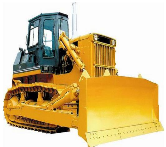
El bulldozer se utilizan para las siguientes tareas: Desmante, destronque y limpieza de terreno, Excavación en suelo común o roca, Ejecución de terraplenes, Acarreo de rocas, Aperturas de zanjas, Empuje de otros equipos, Exploración de yacimientos y canteras, Manipuleo de materiales en obra.
