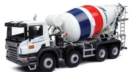
transmixer, camión mezclador o agitador. En minería, debido a las duras condiciones del terreno y secciones pequeñas de galerías y túneles, se utilizan camiones mixers de bajo perfil, que cuentan con potentes motores, compactas dimensiones y permiten una buena movilidad y maniobrabilidad.
