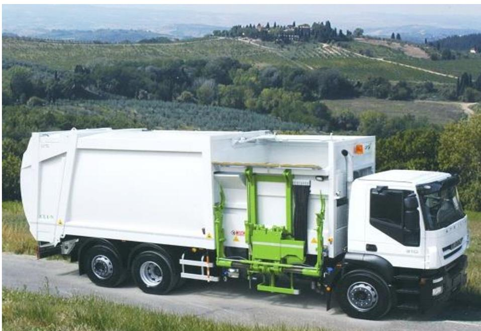
Recolector Compactador de Residuos Carga lateral CLS
