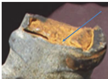
Figura 6.4. Marcas que representan falla por fatiga
