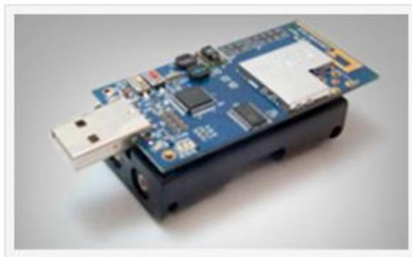
**Ilustración 12:** Dispositivo Inalámbrico Mote (Nodo) [49].
