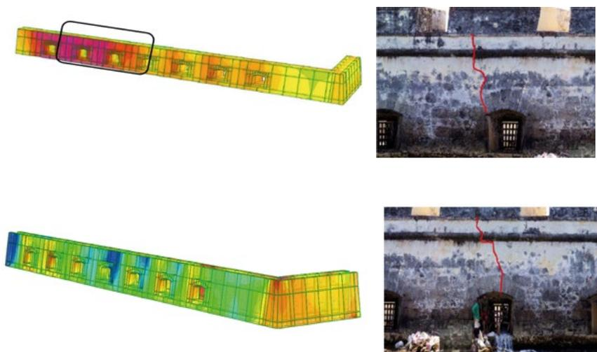
**Ilustración 15. Diagrama de Esfuerzos Cortante S13.
