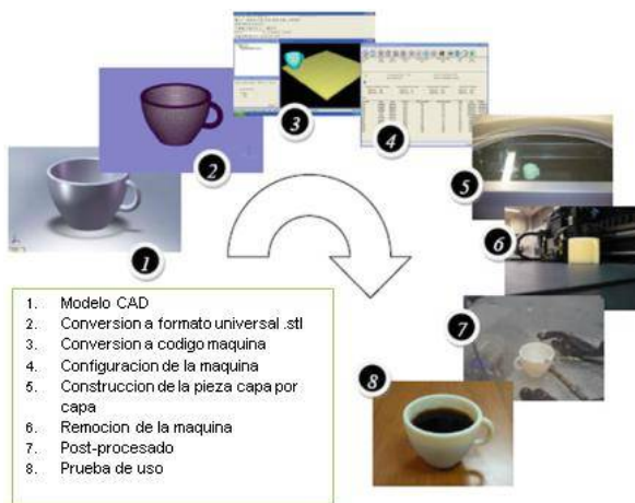
Figura 7. Pasos para construir una pieza en una impresora 3D a partir de un modelo CAD. Fuente: Autor.
