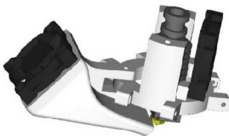
Figura 11. Rediseño del cabezal de impresión para una impresora 3D delta. Fuente: Autor.
