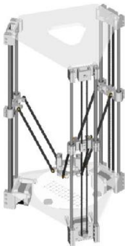
Figura 10. Primer diseño en software CAD para una impresora delta lineal. Fuente: Autor.
