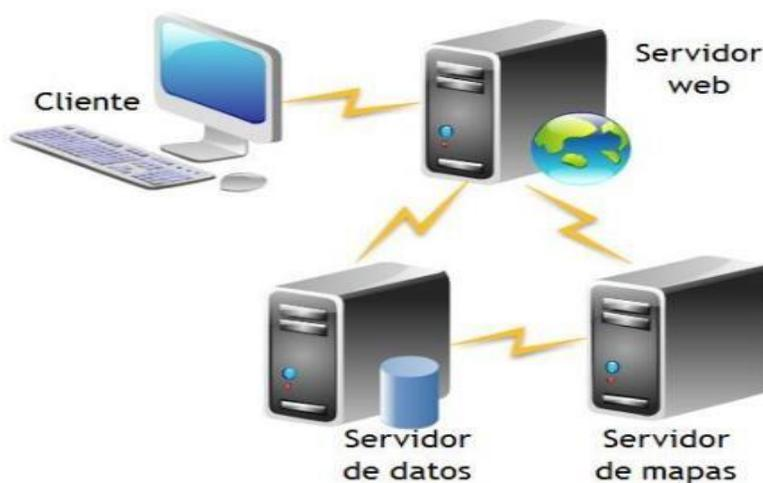
**Figura 1. Componente de un Sistema de Información Geográfico basado en internet**
