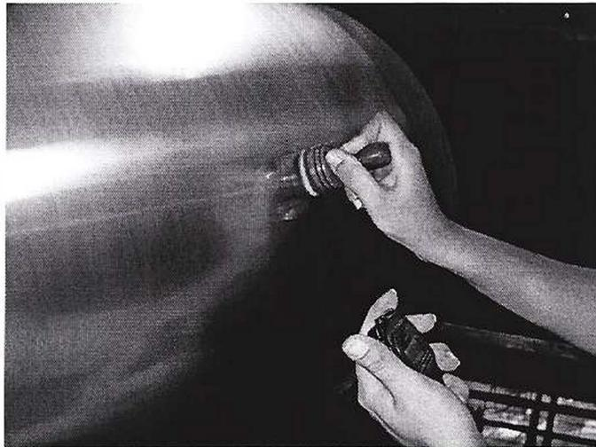
*Figura 6. Aplicación de solvente sobre el tomador de muestras.*
