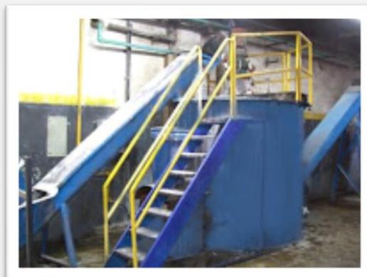
Los trozos de etiquetas, tapitas y guarnición flotan en el agua y son arrastrados por paletas agitadoras, hasta desbordar y puede ser recuperado, lavado, secado, extrudado y comercializado. Luego del lavado en caliente, las escamas de PET pasan por una serie de bateas de enjuague con agua.
