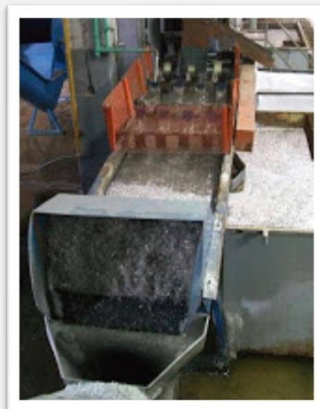
El PET es transportado mediante tornillos sin fin a tanques de lavado con una solución acuosa de lavado caliente y agitación para eliminación de suciedad adherida a las escamas de PET. La solución de lavado se compone de agua, soda cáustica y tensoactivos.
