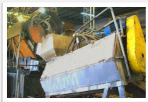
de las etiquetas. Las paredes metálicas del equipo presentan perforaciones, de aproximadamente 5cm, que permiten la eliminación de las etiquetas, mientras que las botellas continúan su marcha hacia la siguiente etapa del proceso. <sup>7</sup>
