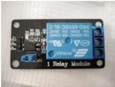
Figura 6. Módulo Relay.
