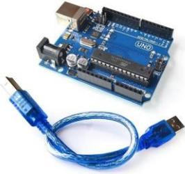
Arduino UNO es una placa basada en el microcontrolador ATmega328P. Tiene 14 pines de entrada/salida digital (de los cuales 6 pueden ser usados con PWM), 6 entradas analógicas, un cristal de 16Mhz, conexión USB, conector jack de alimentación, terminales para conexión ICSP y un botón de reseteo. Tiene toda la electrónica necesaria para que el microcontrolador opere, simplemente hay que conectarlo a la energía por el puerto USB ó con un transformador AC-DC
