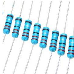
Resistencia azul se utilizan para marcar las resistencias no inflamables y las resistencias fusibles
