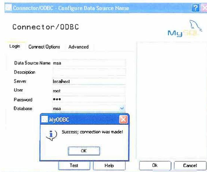
En el servidor de Datos MySQL se deben importar las Bases de Datos MSA con sus respectivas tablas: Hosts, Sala, Mensaje, Reporte y Movimiento.
