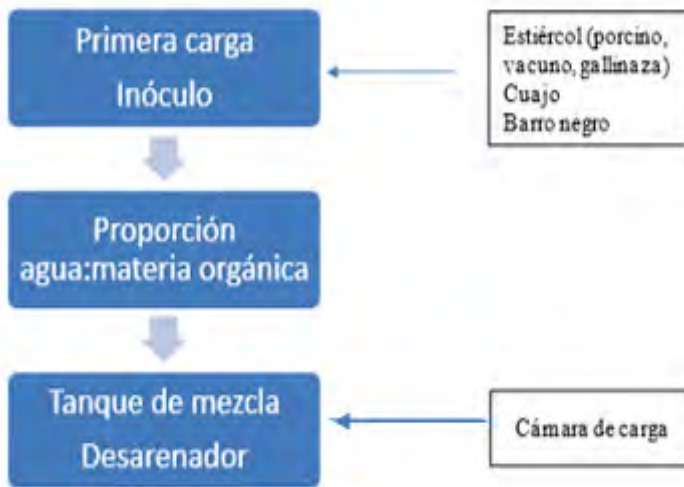
Figura 13. Esquema de carga de un biodigestor tubular
