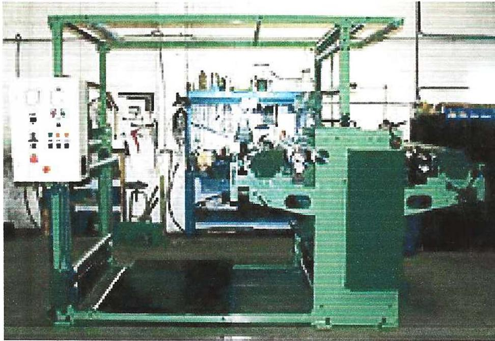
**Figura 15. Máquina impresora flexográfica de 600-1600/6 colores**
